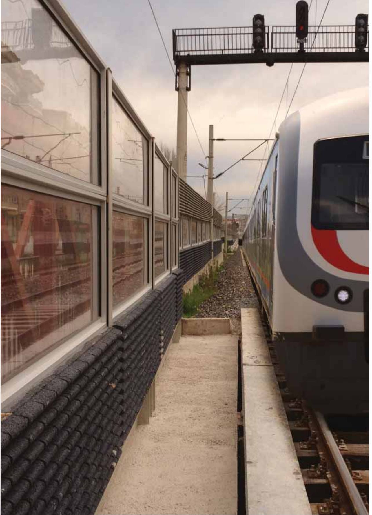
Demiryolu Gürültü Bariyeri, İzmir Policam SoundBlock, PMMA 15 mm
